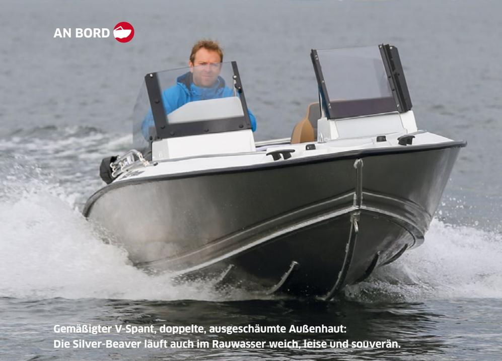
Gemäßigter V-Spant, doppelte, ausgeschäumte Außenhaut: Die Silver-Beaver läuft auch im Rauwasser weich, leise und souverän.
