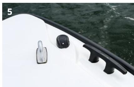
**3+4+5** Solide Details: Die in einem doppelten Metallwinkel gehaltene Windschutzscheibe, ein praktischer Fenderhalter im Vorschiff, der solide Metallbügel auf dem Vorschiff zum Anschließen und Sichern des Bootes am Steg und stabile, gut dimensionierte Festmacherklampen.
