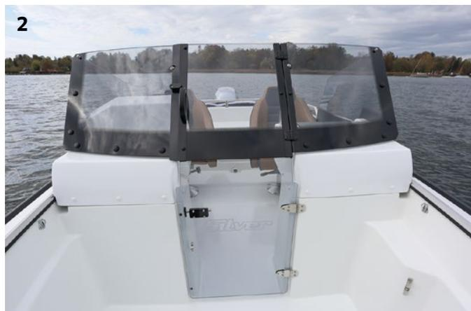
**1** Ins geräumige vordere Staufach passt ein Ankergeschirr und mehr. **2** Der Durchgang kann mit einer Pforte und dem Mittelteil der Windschutzscheibe verschlossen werden. **3** Blick ins aufgeräumte Cockpit. Für die Rückbank sind eine Polsterauflage und ein Rückenpolster erhältlich. **4** Die Bugsektion bietet viel Platz und ist ideal, um die Angel auszuwerfen. Optional kann eine kleine Bugreling montiert werden.
