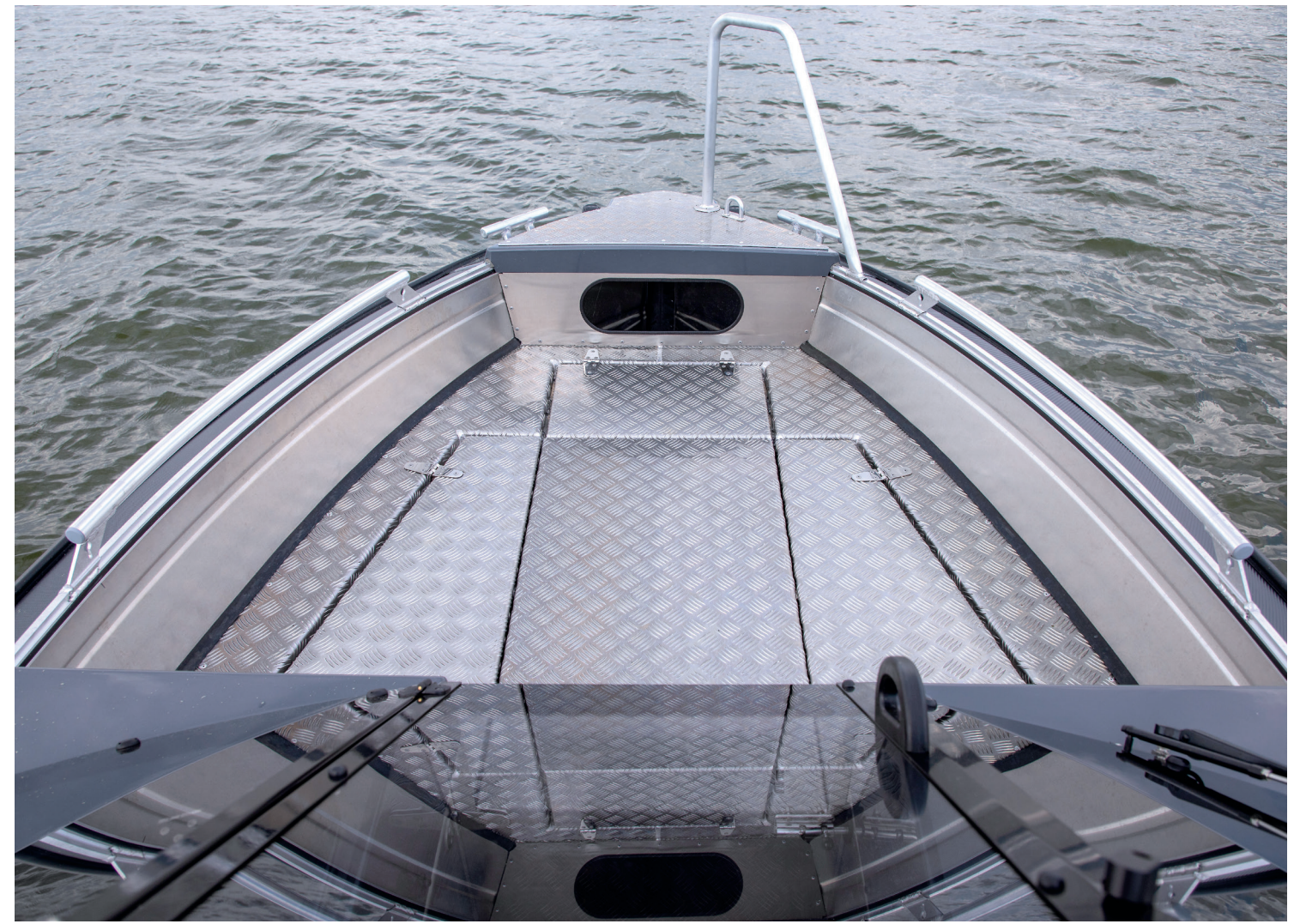
BRX-versiossa etukannelle saa kulkuväylän kattavan lisäosan, jolloin etukannesta muodostuu yhtenäinen korotettu taso, joka soveltuu esimerkiksi heittokalastukseen.
